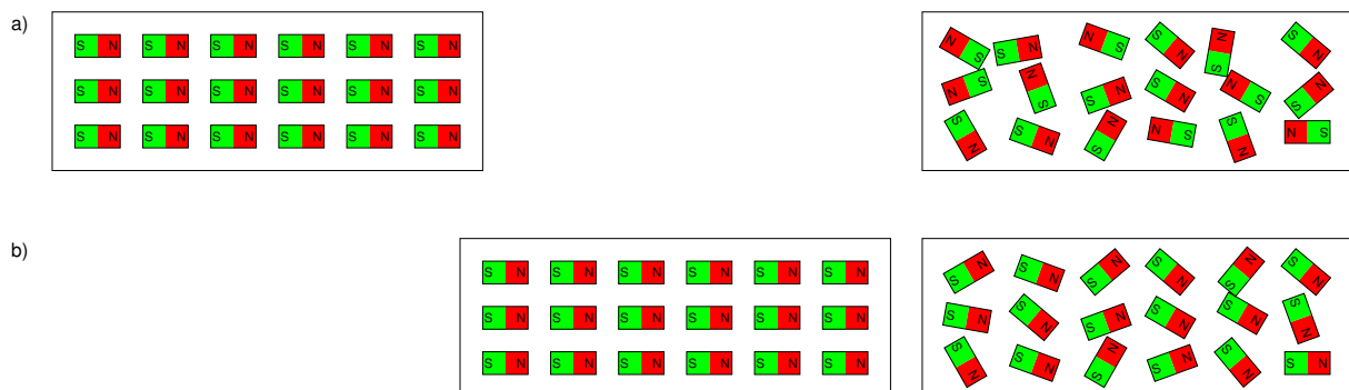
Abbildung 4: a) Normalerweise sind die Elementarmagnete im Eisen ungeordnet. b) Bringt man einen Magneten in die Nähe von Eisen, dann ordnen sich die Elementarmagnete etwas aus. Das reicht aus um das Eisen schwach magnetisch zu machen. Magnet und Eisen stehen sich mit ungleichnamigen Polen gegenüber und ziehen sich an.
