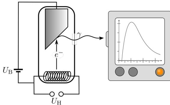
Abbildung 4.1: Röntgenröhre mit Spektroanalysator
