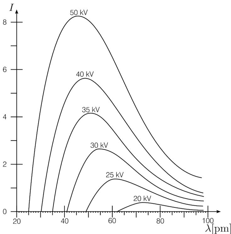
Abbildung 4.2: Intensität  $I$  der Röntgenstrahlung in Abhängigkeit von der Wellenlänge  $\lambda$  bei verschiedenen Beschleunigungsspannungen  $U_a$ . Die Intensität ist ohne Einheit dargestellt, da der absolute Wert für die Auswertung nicht benötigt wird.
