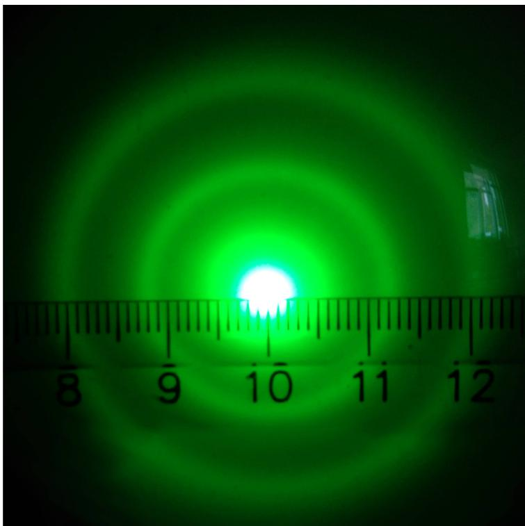
Abbildung 7.2: Beugungsbild einer Elektronenröhre mit einer Spannung von 4 kV.
