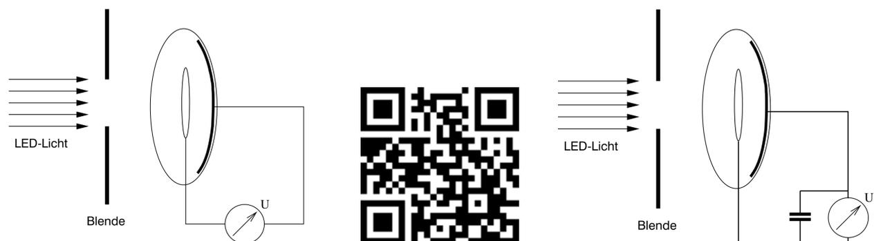
Abbildung 1.1: Schematischer Aufbau zu den Versuchen mit der Vakuumpfotозelle. Links: ohne Kondensator, Mitte: QR-Code für die App, Rechts: mit Kondensator
